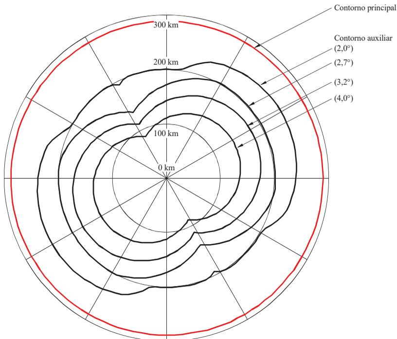
Los contornos auxiliares del modo de propagación (2) se muestran para ángulos de evitación del haz principal de la estación terrenal de 2,0°, 2,7°, 3,2° y 4,0° respectivamente.
