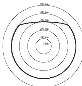
b) Ejemplo de contorno de coordinación de una estación terrena con una antena de seguimiento que funciona con una estación espacial no OSG como las de los § 1.4.2 y 1.4.3
