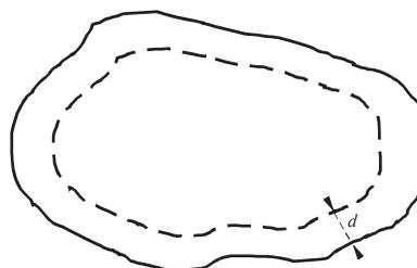
d) Ejemplo de contorno de coordinación de una estación terrena que funciona en una zona de servicio especificada como la de los § 1.4.5, 1.4.6 y 1.4.7. El contorno de coordinación corresponde a la línea exterior continua, y la zona de servicio especificada, a la línea interior discontinua. La distancia de coordinación,  $d$ , puede tener un valor constante, o variar con el acimut, dependiendo del caso de compartición y del tipo de servicio de radiocomunicaciones
