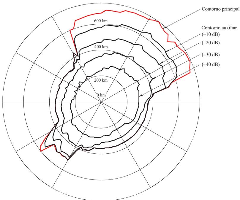
Los contornos auxiliares del modo de propagación (1) se muestran para ajustes de -10, -20, -30 y -40 dB en las pérdidas mínimas requeridas.
