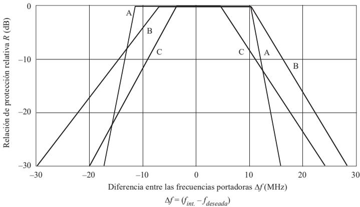
Curvas A : señal deseada TV/BLR, señal interferente TV/MF
